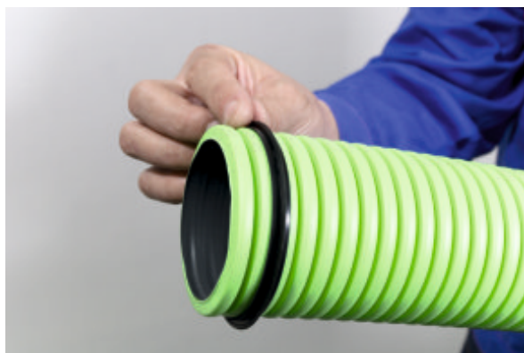
2) Do 2. nebo 3. drážky nasadíme těsnící kroužek.
